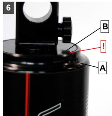
Replacer le cylindre sur l'amortisseur et revisser jusqu'à alignement des autocollants, assurez-vous que le cylindre (A) soit bien tangent avec la cloison (B) de la chambre d'air (image 6).
