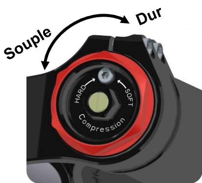
Régler l'amortissement en compression à l'aide du tournevis plat en agissant sur la vis de compression au centre du bouchon de la cartouche supérieure.
