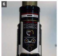
Assurez-vous que la molette de détente et l'autocollant collé sur la chambre positive (a) soient bien alignés.
