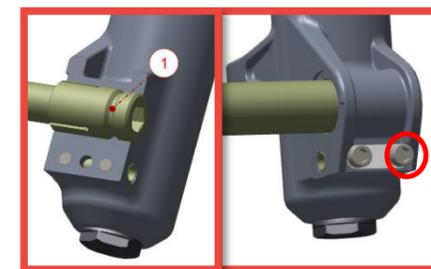
Lors du démontage des axes de **15 mm x 110 mm**, veillez à ne pas desserrer la vis de droite (entourée en rouge sur l'image) afin d'éviter que l'insert (**1**) ne se déplace. Cette précaution ne concerne pas les axes de **20 mm x 110 mm**. Le couple de serrage pour chaque vis est de **4 Nm**.
