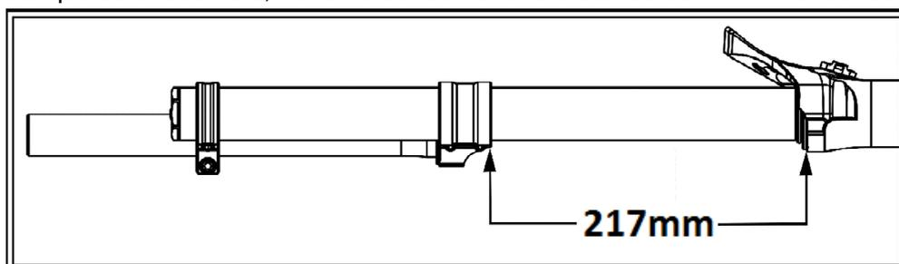
La cote se mesure sur le plongeur, du haut du fourreau (base visible du joint) au bas du té
